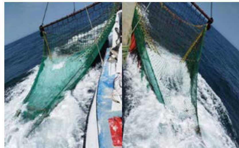
Figuur 1 - Standaard net (links) en experimenteel net met grote mazen (rechts) aan boord van de Z-67 'Rubens'
